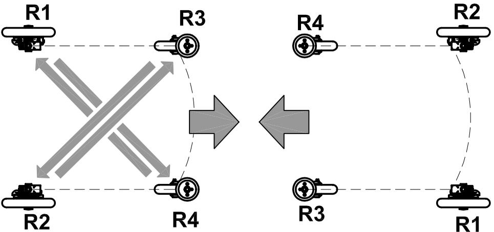
**B** GRILLO FRONT-DRIVE GAIT TRAINER: DISASSEMBLING THE WHEELS
