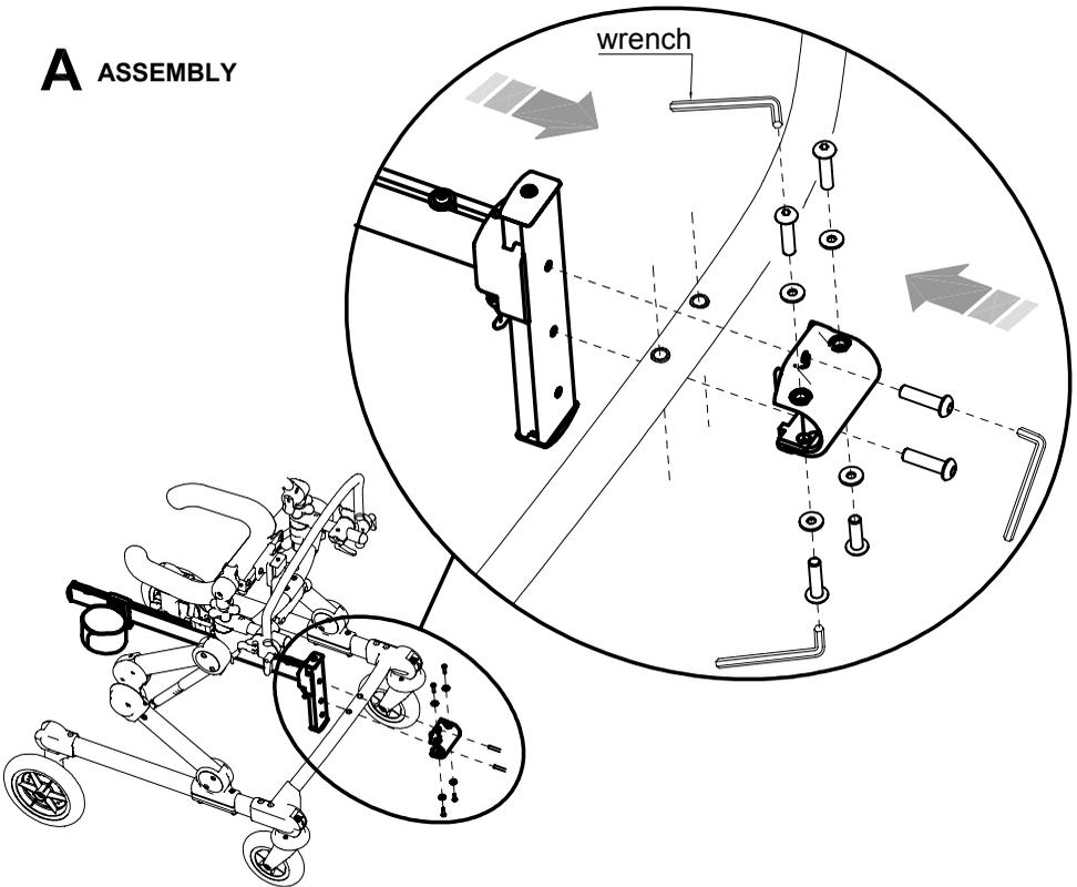
**LEG DIVIDER CONNECTED TO THE FRAME**
